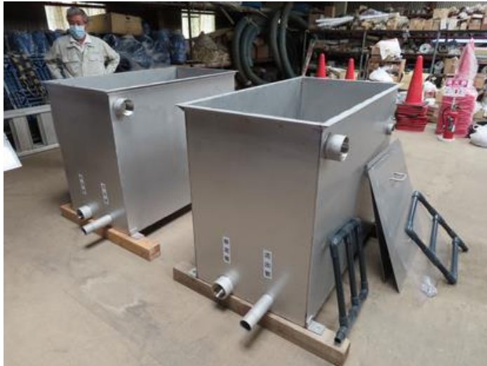
簡易緩速ろ過装置本体
