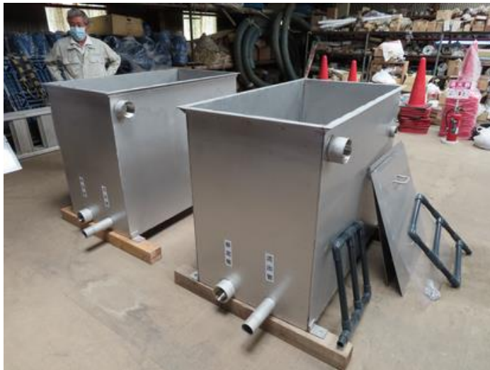
簡易緩速ろ過装置本体
