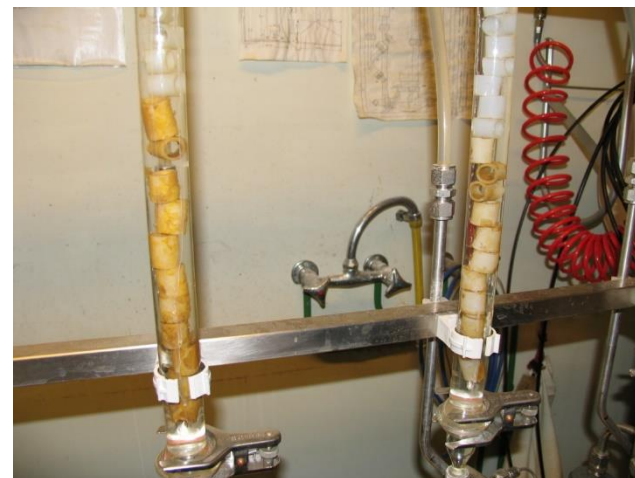
生物膜生成試験装置（KWR所有）
